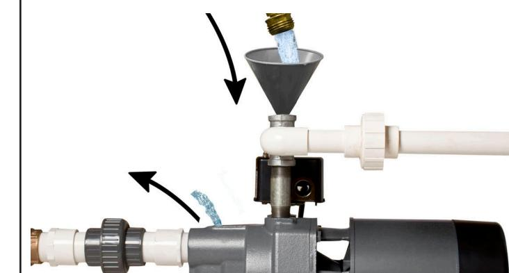
2. Llene lentamente la cavidad de la bomba hasta que salga agua del orificio de descarga de aire en la parte superior de la bomba. (Fig. 2)
