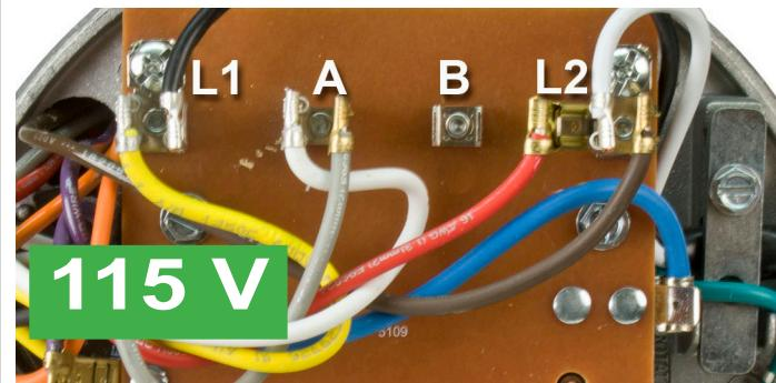
1. El motor de esta bomba es de doble voltaje y puede funcionar a 115 V o 230 V. En general, es más económico que opere a 230 V y requiere un tamaño de cable más pequeño. La mayoría de los modelos de 0.3 y 0.5 kW están preajustados de fábrica para funcionar a 115 V. (Fig. 1)
