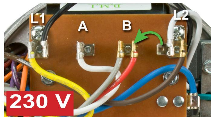
b. Hale el cable rojo con el conector hembra del terminal "L2". Colóquelo a la izquierda, en el borne de pala del terminal "B". (Fig. 2b)
