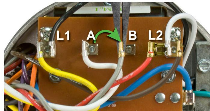
a. Con un par de pinzas de punta de aguja, hale el cable gris con el conector hembra del lugar del borne de pala del terminal "A". Colóquelo a la derecha, en el borne de pala del terminal "B". (Fig. 2a)
