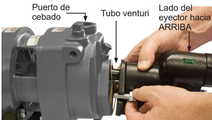
Fije el eyector a la cara de bomba con los dos (2) pernos y juntas proporcionados. El tubo Venturi del eyector se inserta en la rosca superior de la cara de la bomba. **NOTA:** Los modelos de 0.3 y 0.5 kW tienen un eyector incorporado.
