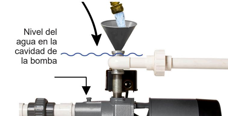
3. Vuelva a colocar el tapón de descarga de aire y continúe agregando agua a la cavidad de la bomba hasta que el agua llegue a la parte superior del tapón de cebado. (Fig. 3)
