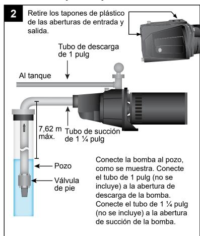
Conecte la bomba al tanque (no se incluye), como se muestra. La mayoría de los tanques de presión cuentan con un codo de entrada de 1 pulg en la parte inferior. Usando conectores de 1 pulg (no se incluyen), conecte este codo a la bomba, como se muestra. Se recomienda usar una unión (no se incluye) para facilitar la conexión.
