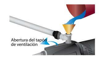
b. Llene lentamente el conector de descarga con agua hasta que esta desborde la abertura del tapón de ventilación. NOTA: antes de encender la bomba, vuelva a colocar el tapón de ventilación sin apretarlo y abra varias salidas o grifos para permitir el flujo de agua durante el cebado.
