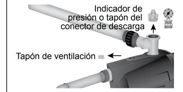
a. Retire el indicador de presión o el tapón del conector de descarga (no se incluye) ubicado en la parte superior de este (no se incluye).
