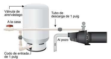
La presión de aire en el tanque debe ser 2 PSI menor que la "presión de activación" del interruptor de presión. La bomba tiene un interruptor de presión de 20/40 PSI, por lo que la presión del tanque debe ser de 18 PSI. Compruebe la presión con un indicador de presión para neumáticos (no se incluye) y agregue o quite aire según sea necesario.
