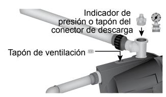
c. Asegúrese de que el nivel del agua en la cavidad de la bomba sea constante. Si el nivel del agua baja, podría haber una fuga en la válvula de pie. Revise la válvula o el tubo de succión. Si el nivel de agua se mantiene constante, cubra el indicador de presión o el tapón del conector de descarga y las roscas del tapón de ventilación con cinta para roscas y enrósquelos en la bomba. Apriete con una llave de tuercas (no se incluye).
