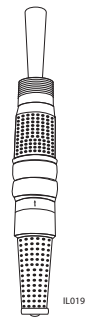
Éjecteur à tuyau simple pour puits profond (diamètre intérieur des puits de 5,08 cm).
